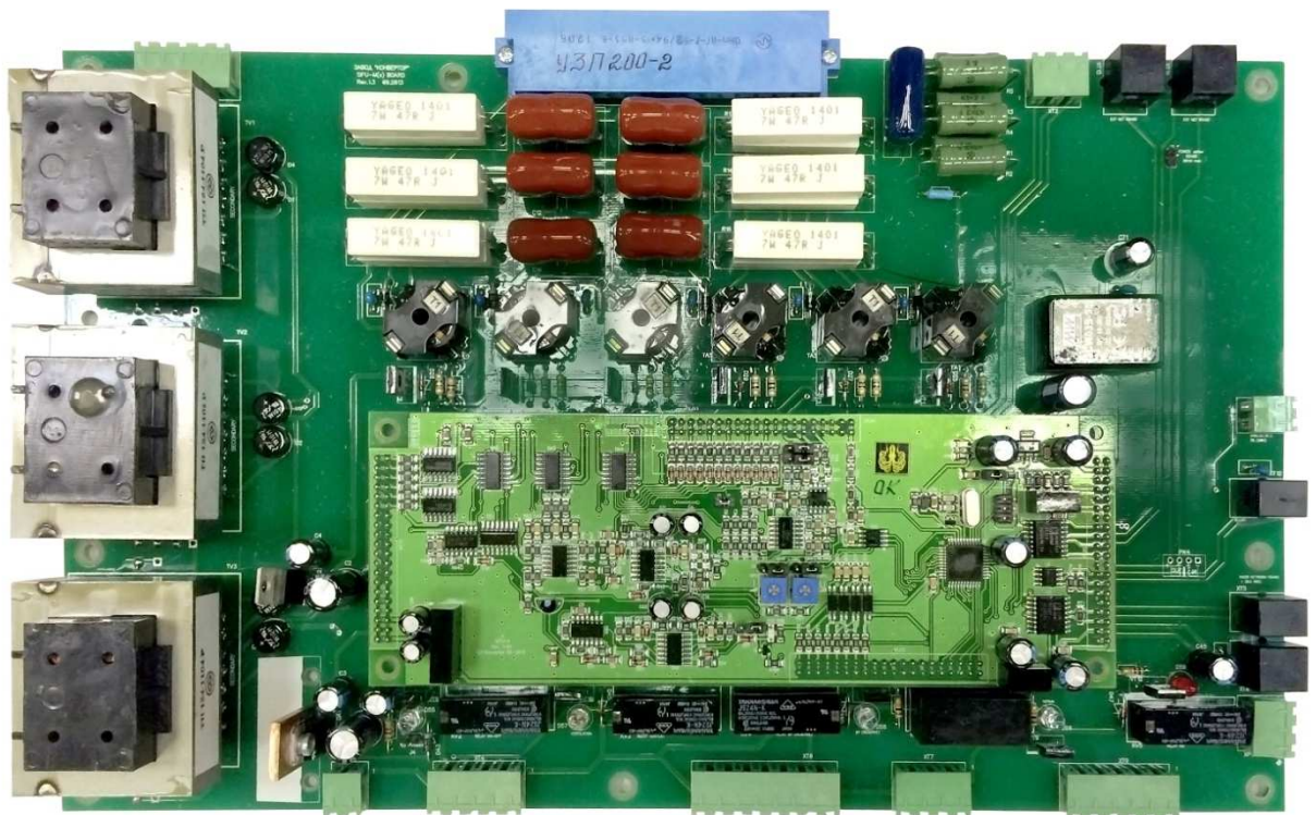
Рис 2. Блок СИФУ-SIFU-X ТГДА.656125.131
