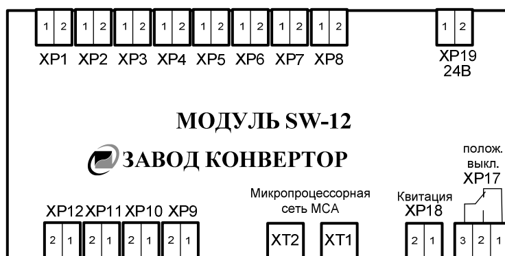
Рис. 9. Схема подключения модуля SW-12 (12 каналов).
