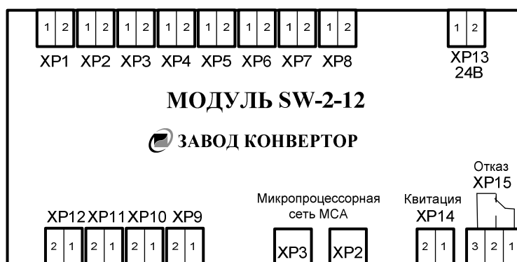
Рис. 11. Схема подключения модуля SW-2-12 (12*2 каналов).
