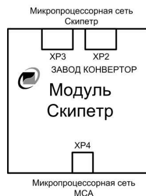
Рис. 15. Схема подключения Модуля Скипетр.
