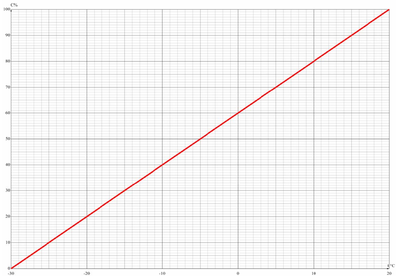
Рис.3. Зависимость емкости элемента от температуры
